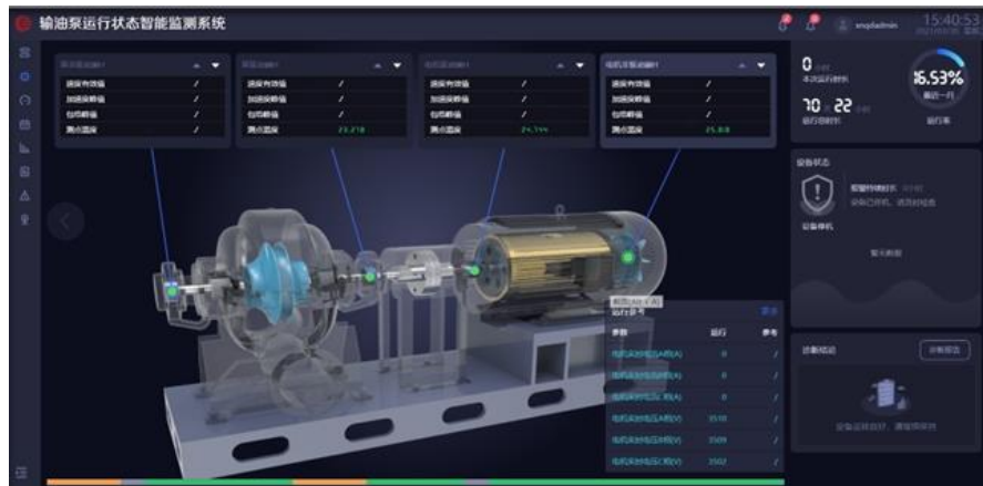
输油泵运行状态智能监测系统
