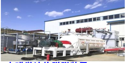
电磁微波热脱附装置
